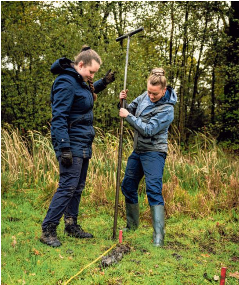
De Vecht bij Ommen. Onderzoeker Nina van Leeuwen en assistent Charlotte Bischof steken een grondboor in de oever op zoek naar oude sedimentatielagen van oude meanderrs van de rivier.
