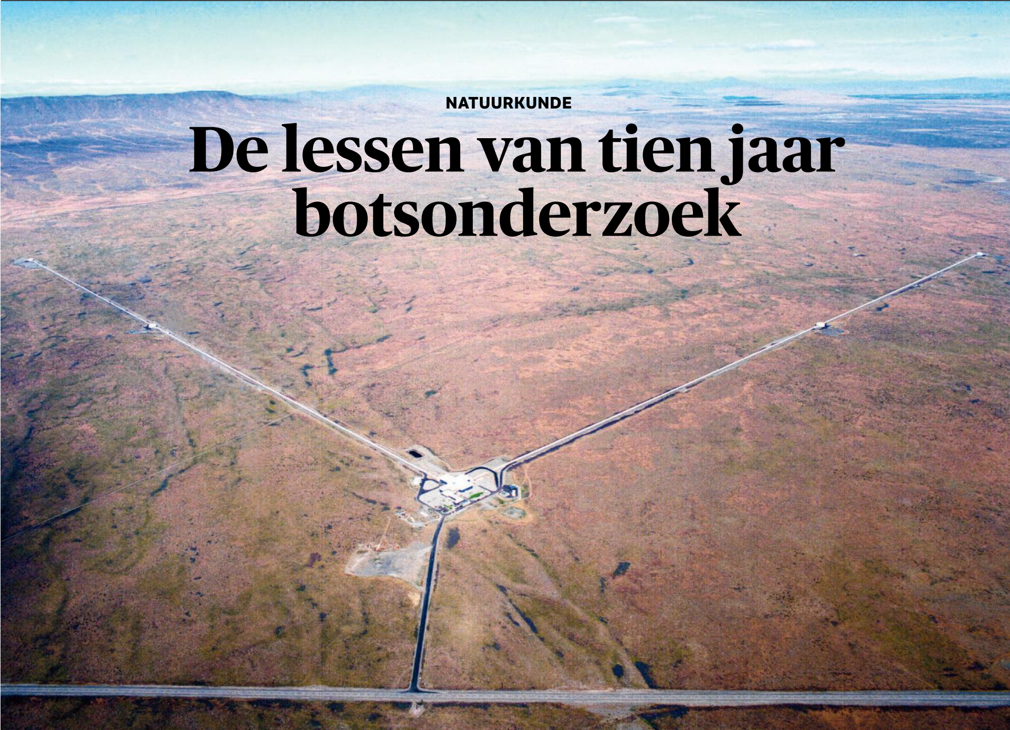
Luchtfoto van een van de LIGO detectors in Hanford, Californië. De armen van de detectors die haaks op elkaar staan zijn vier kilometer lange vacuümbuizen. FOTO SCIENCE PHOTO LIBRARY
