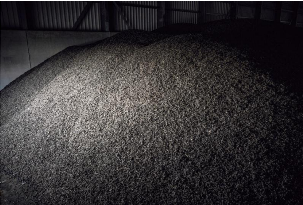
Zwarte rubbersnippers uit oude afvalbanden worden verhit zodat ze uit elkaar vallen.
