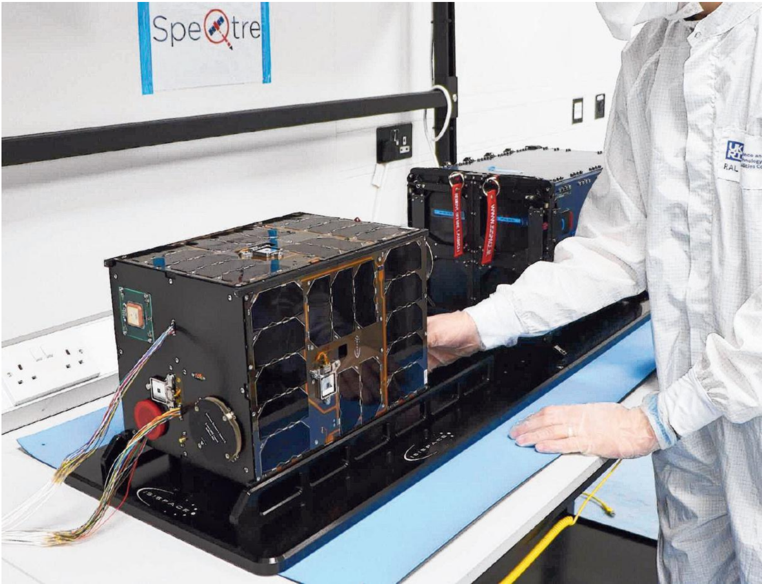
Isispac maakt vele verschillende ‘cubesats’, een kleine satelliet (30 x 20 x 10 centimeter), volgepropt met elektronica. FOTO ISISPAC
