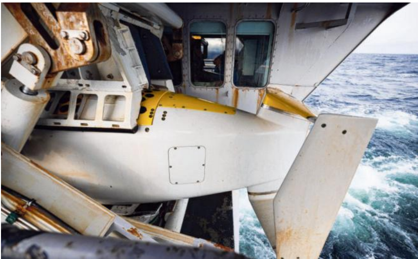
‘De Vis’, sonarapparatuur om onderzeeboten te traceren. Boven: fregat Zr. Ms. Van Amstel in de haven van Bodø. FOTO’S DEFENSIE
